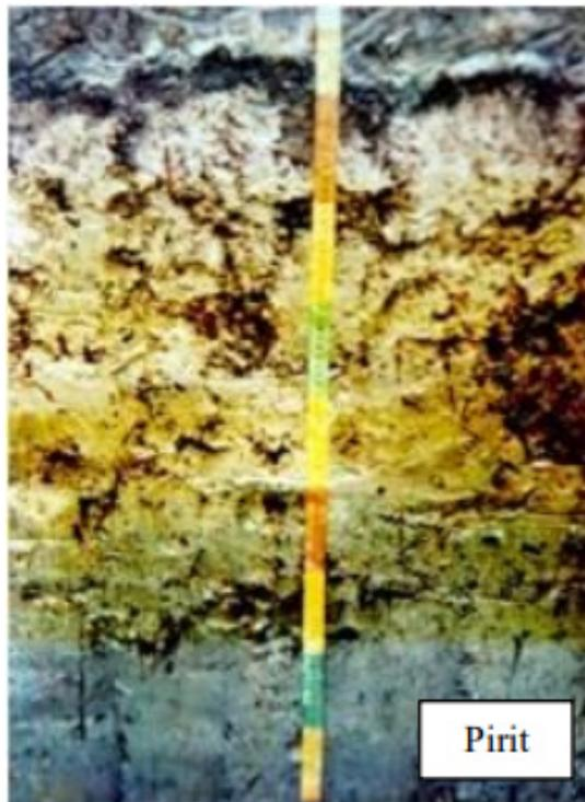
Gambar 1.13 Profil Tanah Sulfat Masam dengan Lapisan Pirit 70-100 cm dengan Warna Kelabu (Grey)
