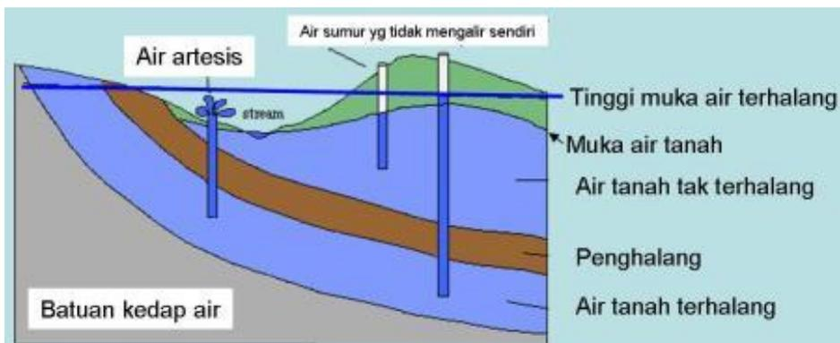
Gambar 6.25 Lapisan Air Tanah
