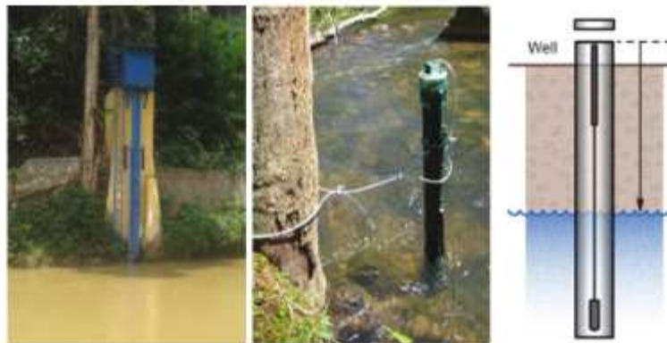
Gambar 2.21 Pengukuran elevasi air dengan menggunakan AWLR (foto kiri), dan dengan menggunakan water logger (foto kanan)
