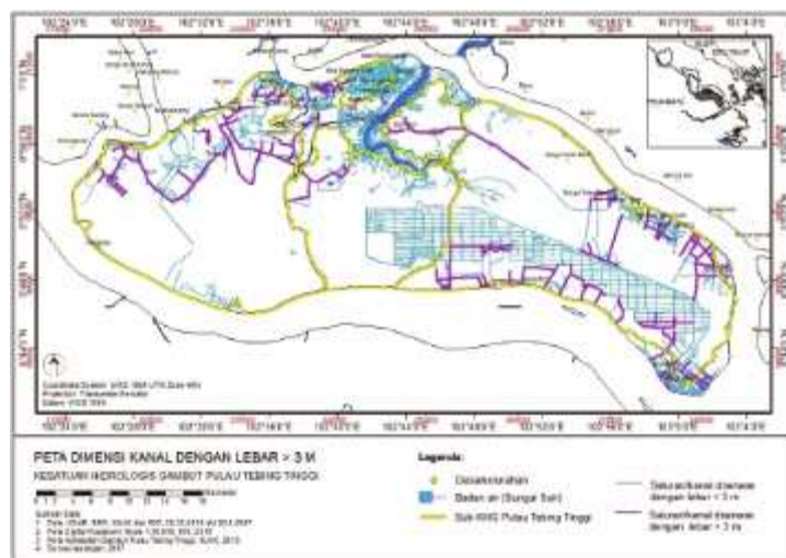
Gambar 5.5 Peta dimensi saluran air (kanal) yang memiliki lebar > 3 m dan kedalaman > 1 m di KHG Pulau Tebing Tinggi
