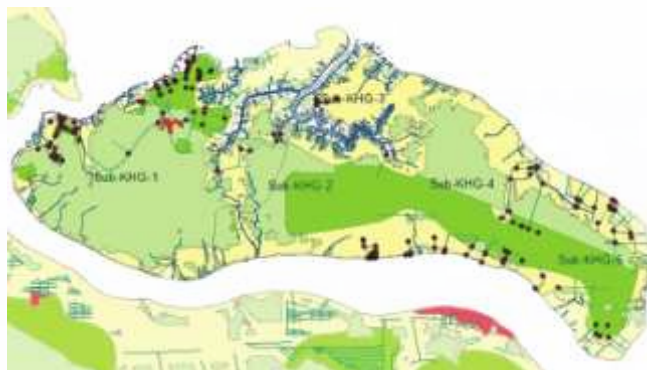
Gambar 5.28 Perencanaan penempatan sekat kanal pada KHG Pulau Tebing Tinggi dengan beda tinggi tidak lebih dari 0,5 m pada kanal-kanal yang memotong kontur.
