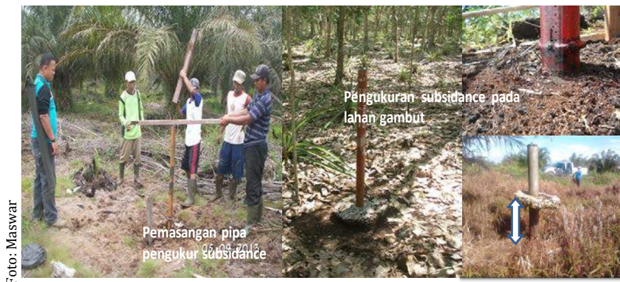
Gambar 12. Proses pemasangan pipa pengukur laju subsiden dan pengukuran penurunan permukaan tanah pada lahan gambut (gambar kanan bawah): contoh kasus penurunan permukaan tanah gambut di Desa Lubuk Ogong, Kecamatan Seikijang, Kabupaten Pelalawan, Provinsi Riau selama periode tahun 2003-2012 sebagai dampak dari pembuatan drainase lahan gambut
