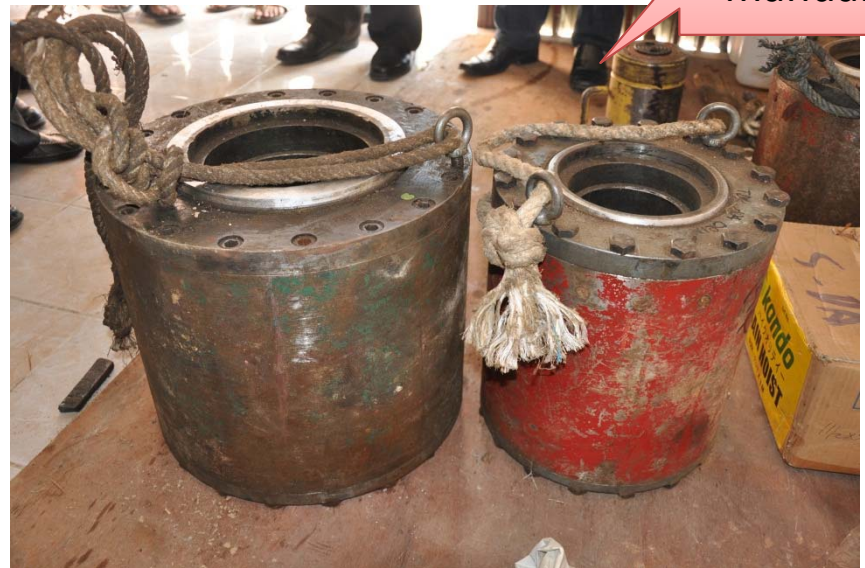
Dongkrak yang digunakan untuk menaikkan titik lendutan dari posisi I ke G
