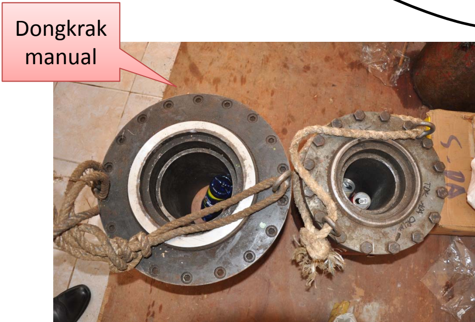
Dongkrak yang digunakan untuk menaikkan titik lendutan dari posisi I ke G
