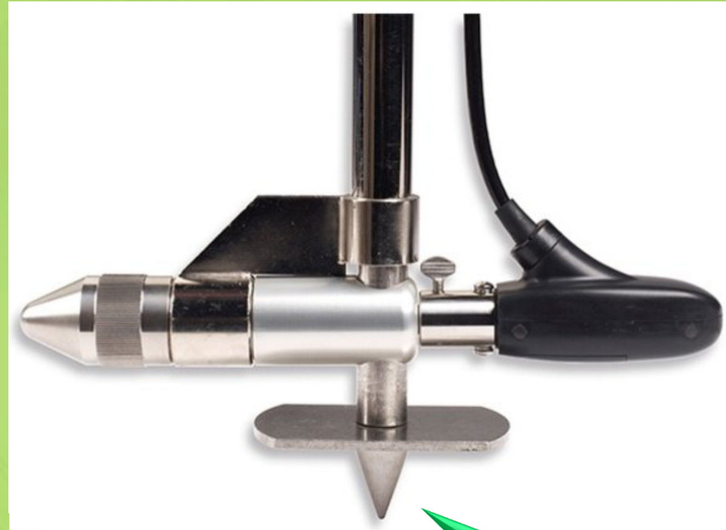
Current meter jenis elektromagnet
