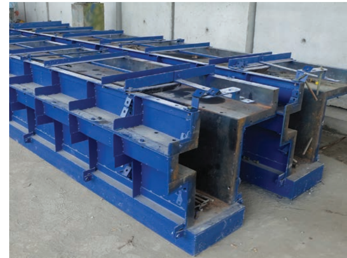
Tidak boleh terjadi deformasi pada alat cetak ( ryan )
