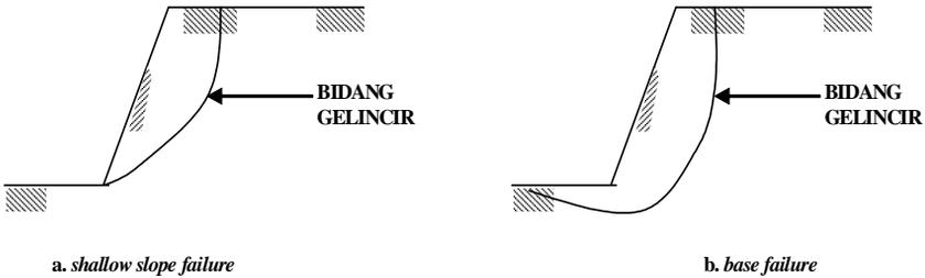
**Gambar 8.1.** Type kelongsoran talud
